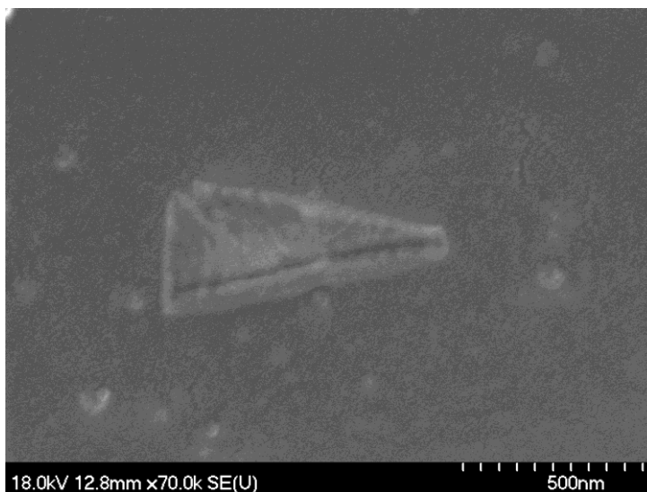
5. kép A Na-poliakrilátról készült SEM fotók 70000-szeres nagyításban.
