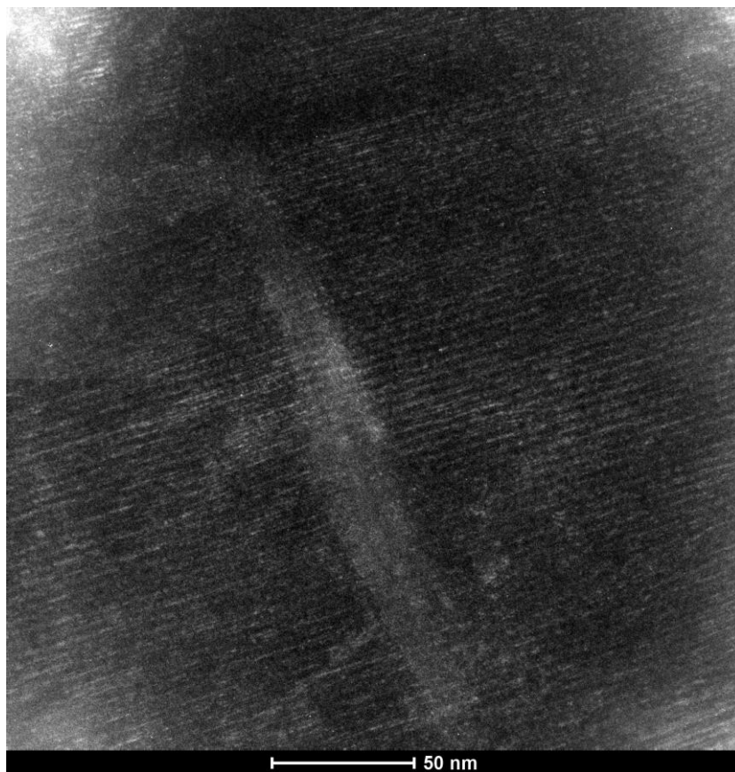
2. kép Poliakrilát-ionnal interkalált \text{Ca}_3\text{Fe-LDH} TEM felvétele
