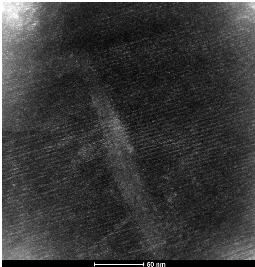
2. kép Poliakrilát-ionnal interkalált \text{Ca}_3\text{Fe-LDH} TEM felvétele
