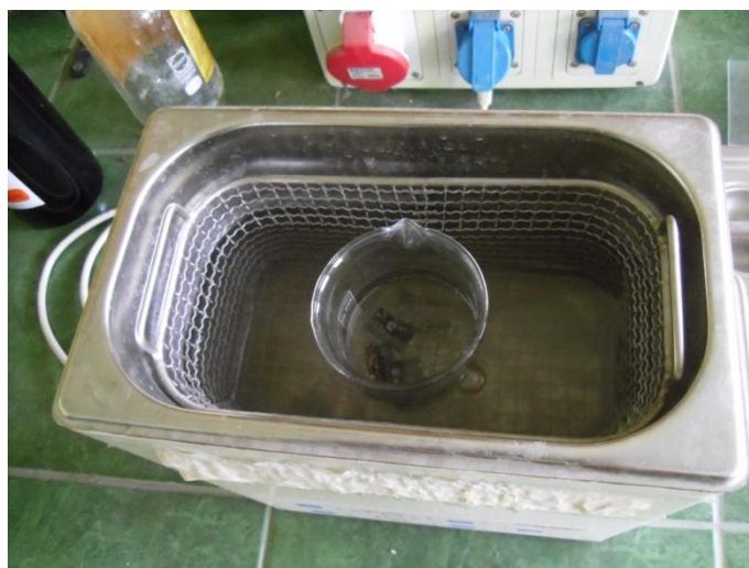
8. kép - Ultrahangos ráztatás (saját kép, 2012)
