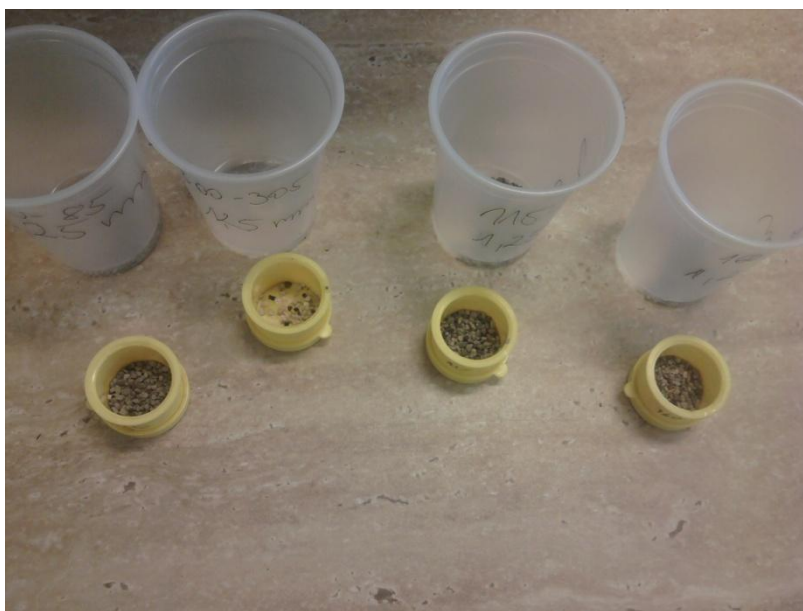
5. kép - Műgyantába ágyazott minták (saját kép, 2012)
