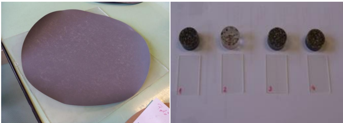
6. kép - A csiszolólap és a már megcsiszolt minták (saját kép, 2012)
