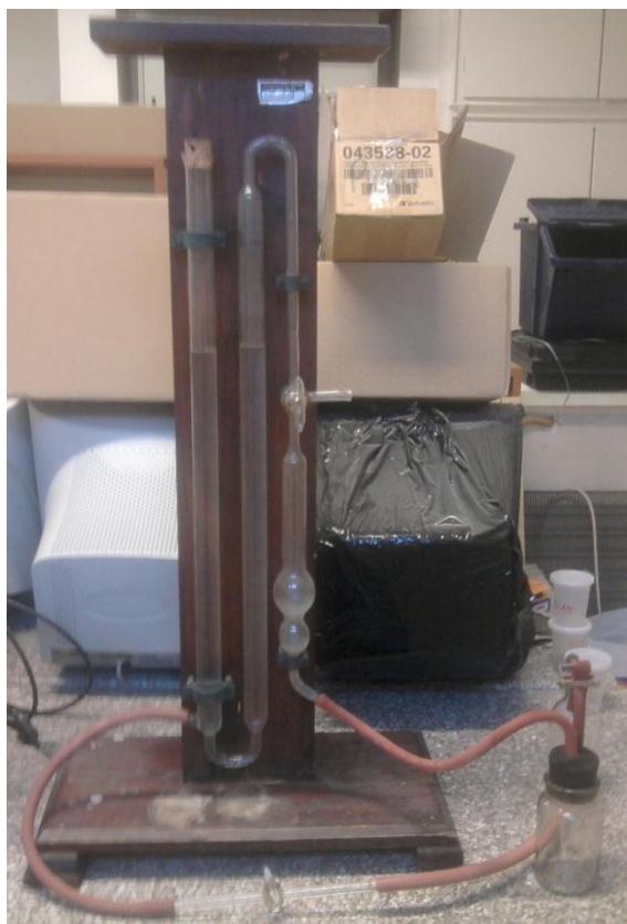
4. kép - Scheibler-féle kalciméter (saját kép, 2012)
