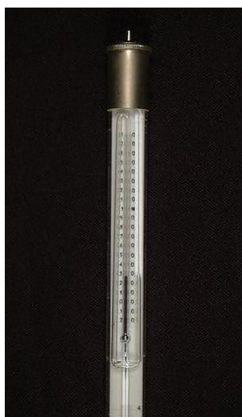
4. ábra: A Beckmann-hőmérő felső része
