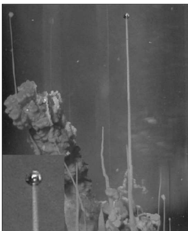
7. ábra. 1 \text{ mol/dm}^3 koncentrációjú nátrium-szilikát-oldatba helyezett \text{Cu}(\text{NO}_3)_2 kristályokból kialakuló csövek [35].
