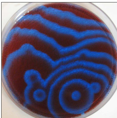
1. ábra. Céltáblamintázat kialakulása a BZ reakcióelegy vékony rétegében. A kísérlet leírása a 12.1. Mellékletben olvasható.
