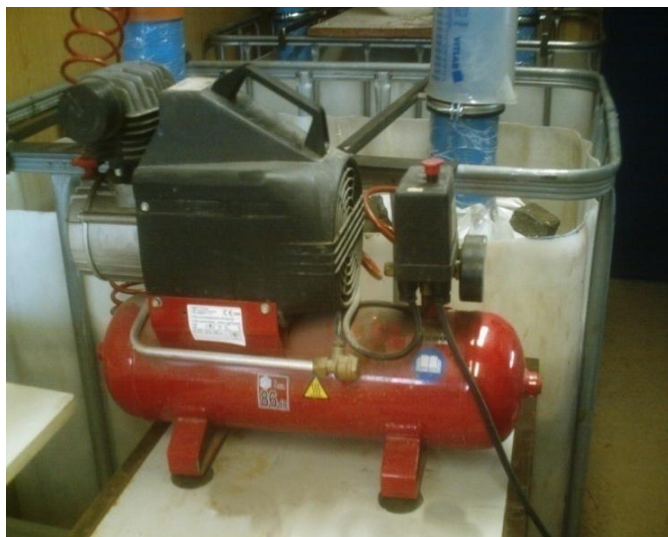
14. ábra: Aerob reaktor levegőztetéséhez használt Pneumair 85/15-A.P. típusú kompresszor
