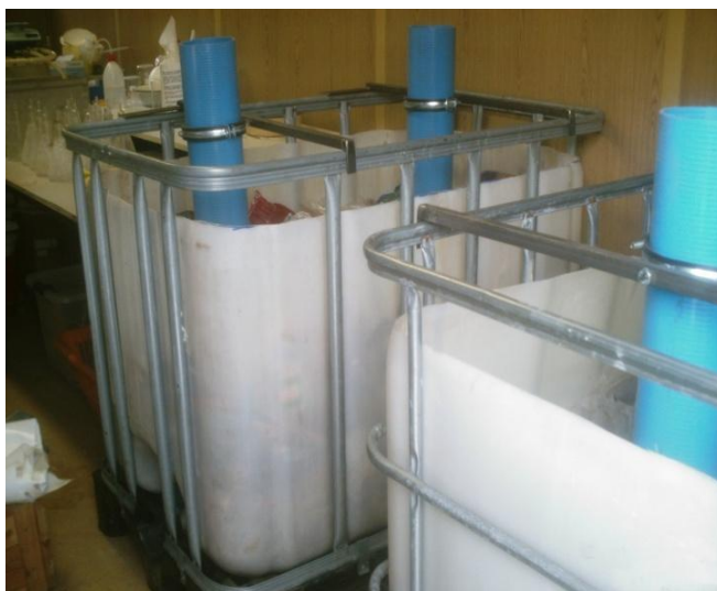
10. ábra: Települési szilárd hulladéklerakókat modellező reaktorok
