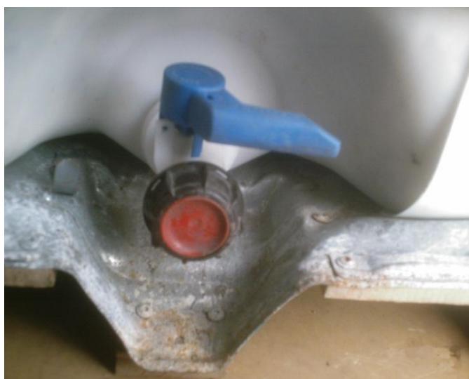
11. ábra: Csurgalékvíz leeresztő csap az egyik reaktor alján
