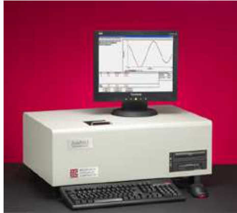
22.ábra: A ZetaPals BIC mérőkészülék (ankersmid.co.ro)
