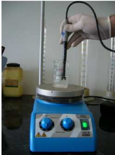
23.ábra.: A mágneses keverő és a digitális pH mérő (Bokányi és társai, 2012)
