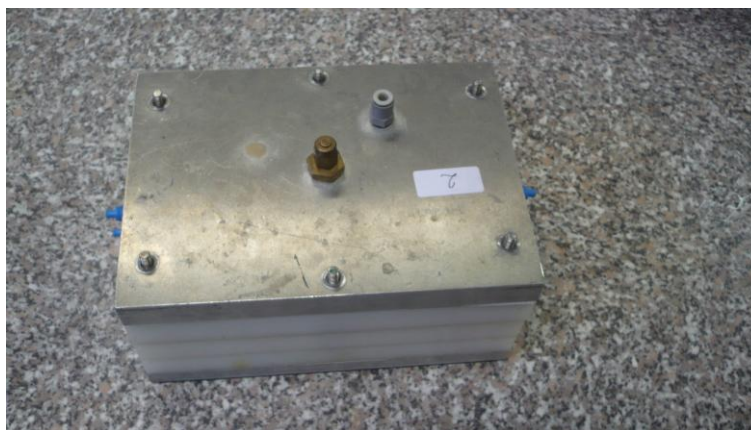
6. ábra DKS- permeabiméter
