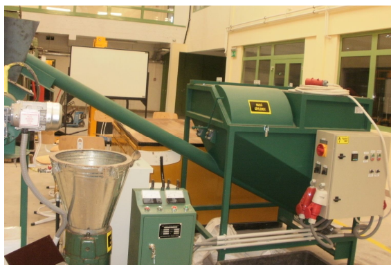
8. kép: Pelletprés a keverővel
