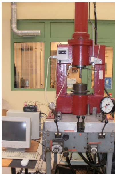
7. kép: Kísérleti dugattyús prés
