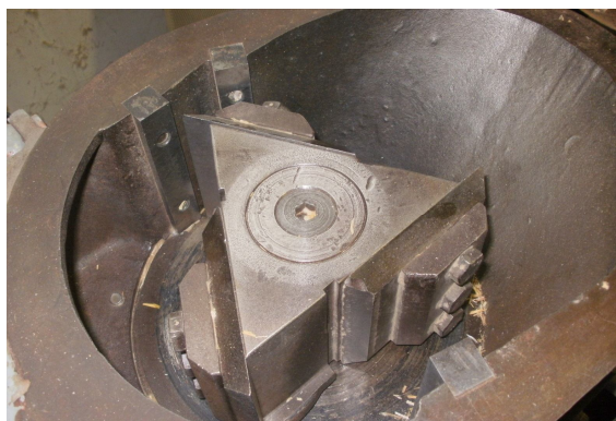
6. kép: Vágómalom belseje, a rotorra illesztett vágókésekkel
