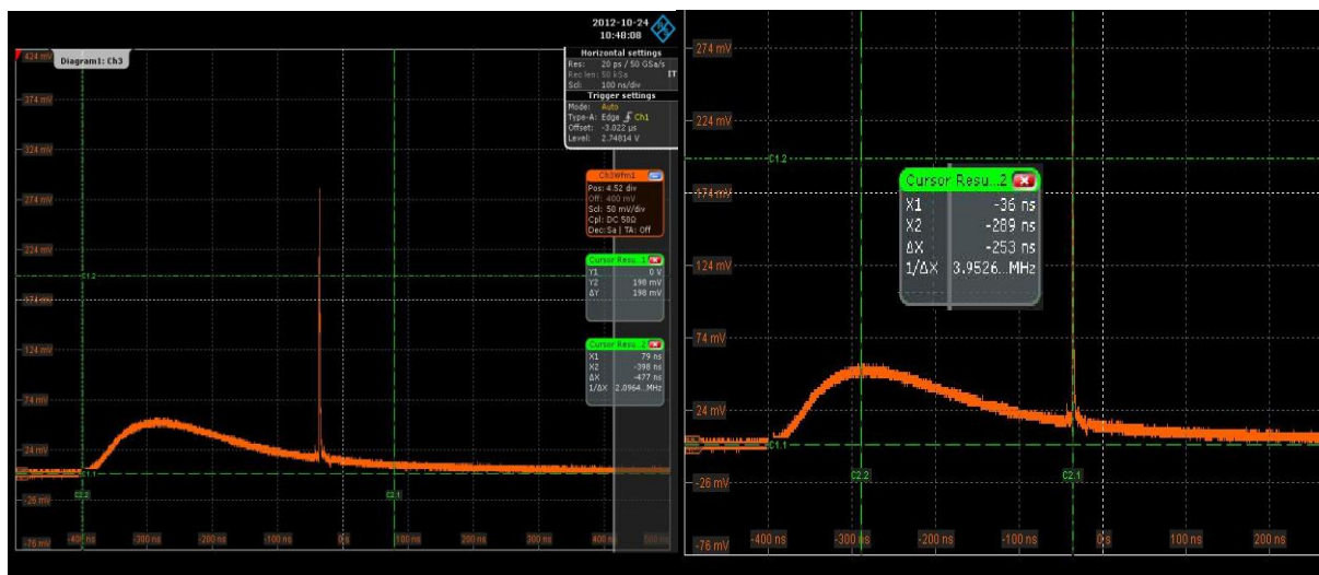
5.2.1. ábra A pumpa- és a magimpulzus időbeli lefutása, és időzítése az első erősítő fokozat után.
