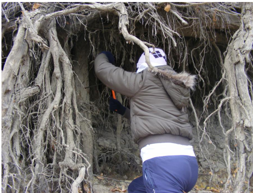
6. ábra: A mintavétel fafűró segítségével gyökerekből történt a meder peremén
