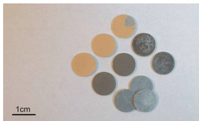
11. ábra: Alumínium korongok mintával, illetve az ülepítés állapota előtt
