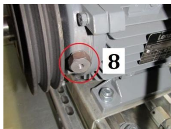
4. ÁBRA – SZENZORFOGLALAT A MOTOR HAJTÓ OLDALÁN VÍZSZINTESEN
