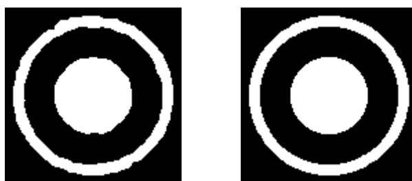
4.8. ábra: A hibás pixelek száma alapján legnagyobb javulást mutató rekonstrukció. Balról a DART, jobbról pedig az ADART algoritmus eredménye látható.
