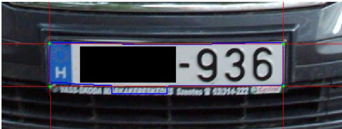
4.9. ábra. A ponthalmazokra illesztett egyenesek és azok metszéspontjai. Kék színnel a szegmentált kontúr látható. A kitakart karakterek anonimitási célt szolgálnak.
