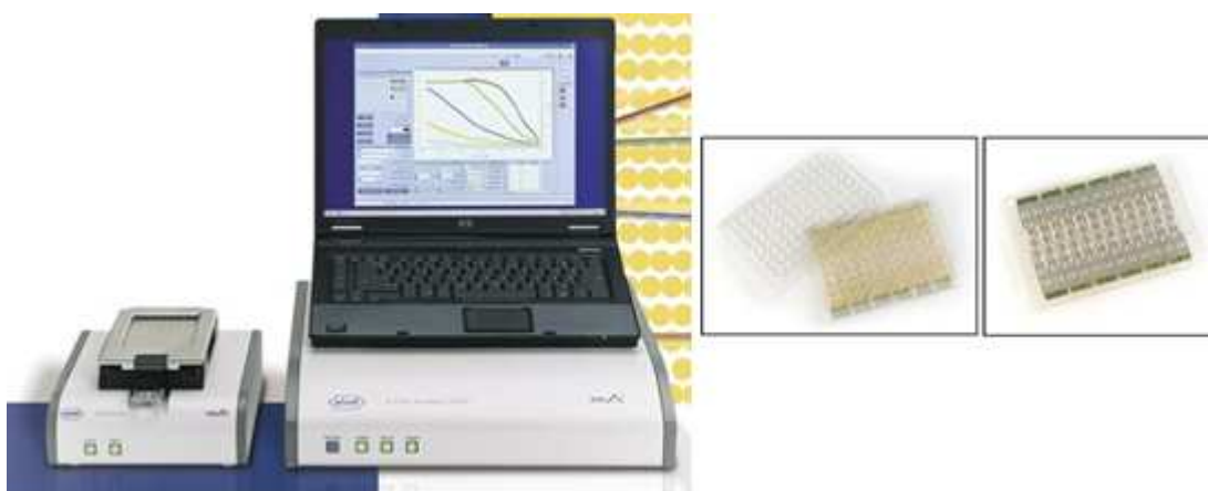
6. ábra. Impedancia mérés xCELLigence rendszerrel és a méréshez szükséges speciális, elektródákat tartalmazó 96-lyukú steril lemez.
