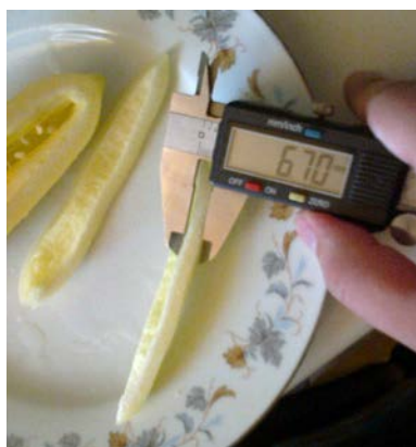
A bogyók húsvastagságának mérése digitális tolómérővel 8. ábra
