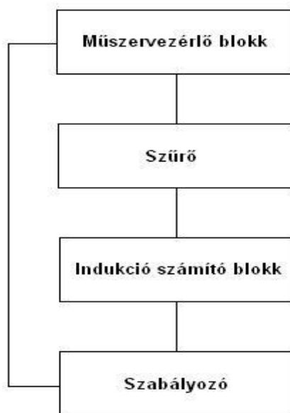
3.2. ábra. A LabVIEW-ba implementált mérőprogram blokkvázlata
