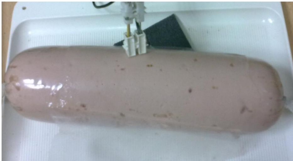
10. Ábra: Az általunk előállított párizsi, és a beszúrt hosszú elektróda
