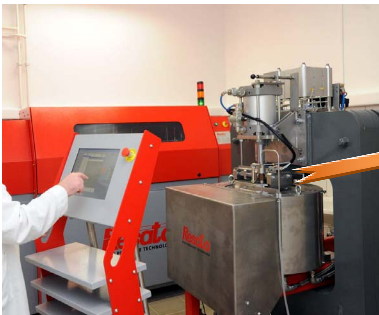
8. ábra A RESATO FPU 1000-2000 nagy hidrosztatikus nyomású berendezés (balra) a kezelőtérbe helyezett gyűjtőcsomagokkal (fent) (Forrás:saját)
