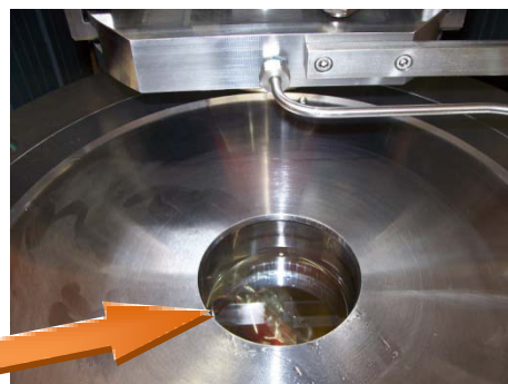
8. ábra A RESATO FPU 1000-2000 nagy hidrosztatikus nyomású berendezés (balra) a kezelőtérbe helyezett gyűjtőcsomagokkal (fent) (Forrás:saját)
