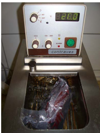
10. ábra Minták tárolása Contraves C40 P folyadéktermosztátban (Fotó: saját)
