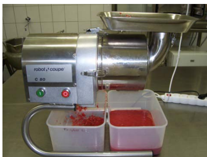
4. ábra Szamócapüré készítése Robot Coupe C80A passzírozó géppel (Forrás: saját)
