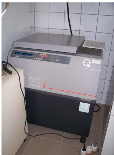
5. ábra Szamócapüré centrifugálása (fent) Jouan CR 22i centrifugával (balra) (Forrás: saját)
