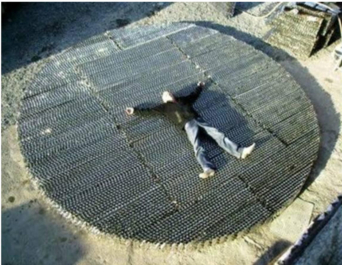
5. ábra Nagyméretű rektifikáló kolonna strukturálttöltete [ http://pr.mk.uni-pannon.hu/disszeminacio/optam.html , 2012]
