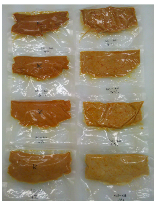
44. ábra Zsír alapú, 40-60; 60-40; 80-20% hús-zsír arányú modellanyag mintasorok HHP kezelés előtt és után. Bal oldalt a kontroll, jobb oldalt a nyomáskezelte minták. Lentről felfelé haladva nő a paprika koncentráció.
