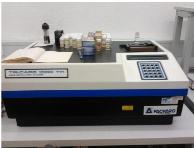
14. ábra: TRI-CARB folyadékszintillációs spektrométer – ELTE Atomfizika Tanszék (Kántor M. 2012)
