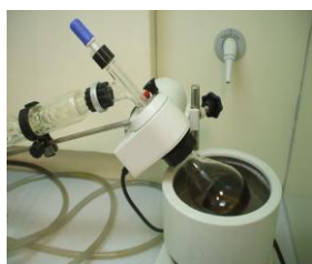
7. ábra: A visszamaradt oldószert vízfürdőn desztilláljuk
