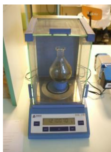
9. ábra: A lepárlási maradékot századgramm pontossággal visszamérjük
