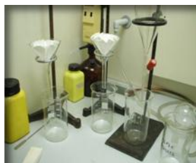
5. ábra: Az oldószeres fázisokat Dören 619 G ¼ szűrőnáníron átszűrjük
