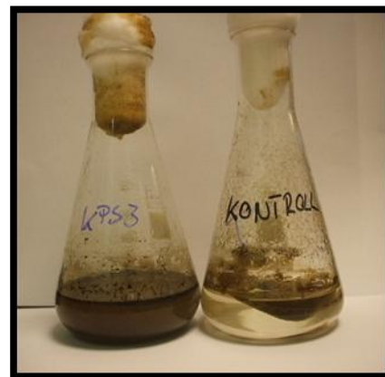
11. számú ábra: A vizuálisan észlelhető emulzióképzés a KPS-3 törzs esetében a kontrollhoz viszonyítva (saját kép)
