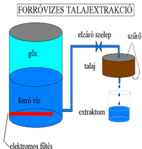
5.ábra: A HWP berendezés működési elve (FÜLEKY & CZINKOTA 1993)
