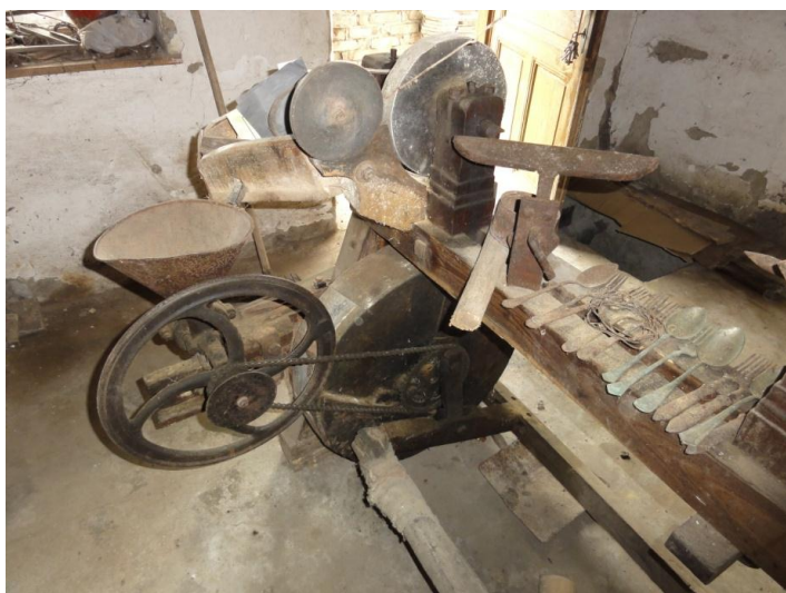
3. ábra: Bendiák Mihály többfunkciós esztergapadja és használati eszközei, 1942-ből (saját felvétel)
