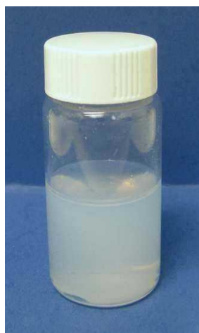
5. ábra: PLGA-ból készült vizes közegű nanoszuszpenzió (átlagos részecskeátmérő: 150 nm, koncentráció: 1 g/l)
