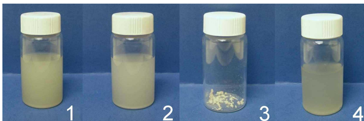
8. ábra: Hatóanyag tartalmú szuszpenziók előállítását követően (1), tisztítás után (2), liofilizált formában (3), és rediszpergálva (4)
