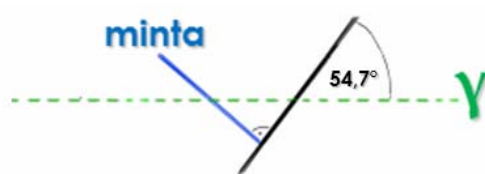
9. ábra: A textúra hatás méréshez használt mérési elrendezés
