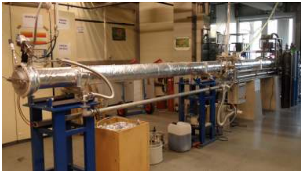
2. ábra. A Karlsruhei Műszaki Egyetemen használt lökeshullám-csőről készült fénykép.
