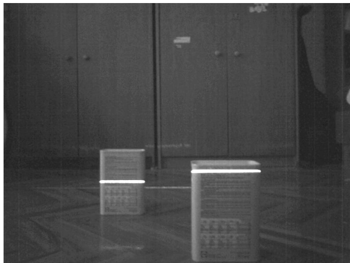
25. ábra Lézer képe azonos szélességű tárgyon különböző távolságokban
