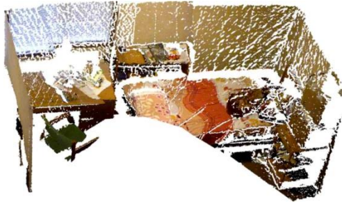
3. ábra – RGB-D szenzor adatai által rekonstruált környezet 3D modellje látható az ábrán [11]. A [11] szerzői ezt a felépített modellt címkézték fel.
