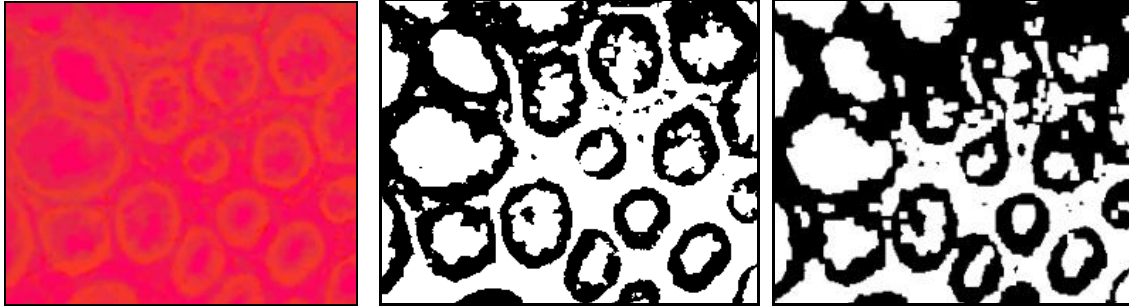
15. ábra: A küszöbölés előtti LAB szintérben levő kép (bal oldal), a küszöbölés utáni kép (középső) és az összekötött komponensek (jobb oldal)
