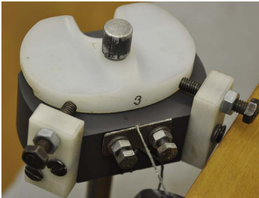
32. ábra Tibiális komponens megfogó – középen a femorális befogón levő tengely horonyba illeszkedő csappal
