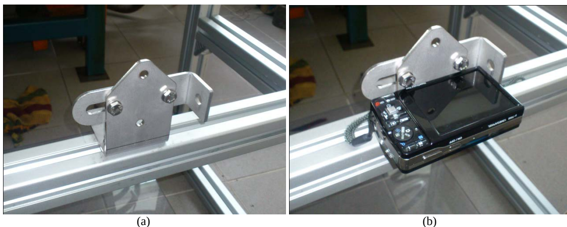
7.4 ábra: Digitális fényképező rögzítése, (a) kialakított konzol, (b) felfogatott fényképező
