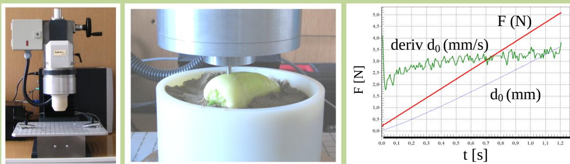
3.12. ábra: Étkezési paprika sérülésvizsgálata DyMaTest mérőberendezéssel. [15][17]
