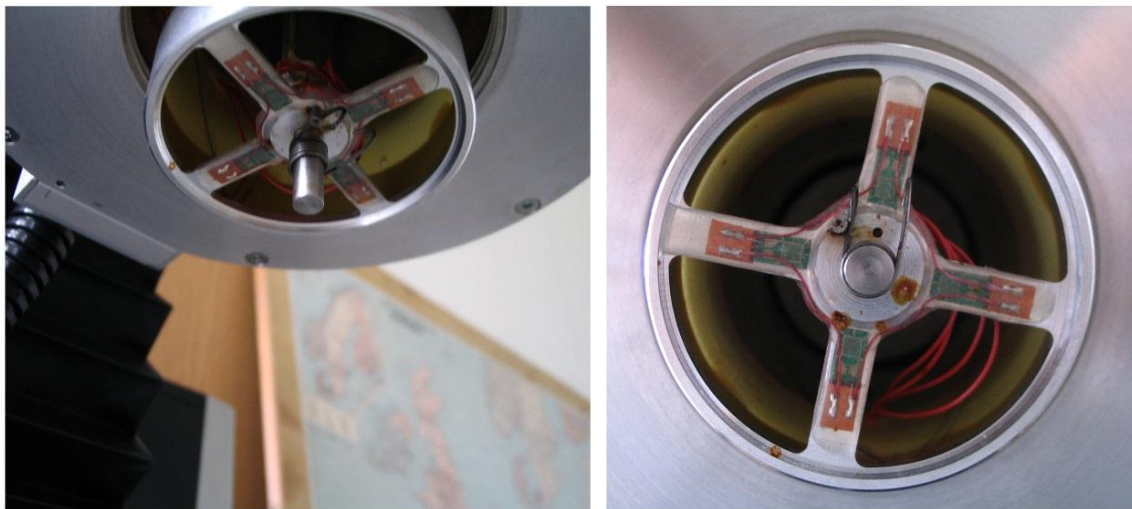
7.2. ábra: Mérőcsap és speciális kialakítású erőmérő cella.
