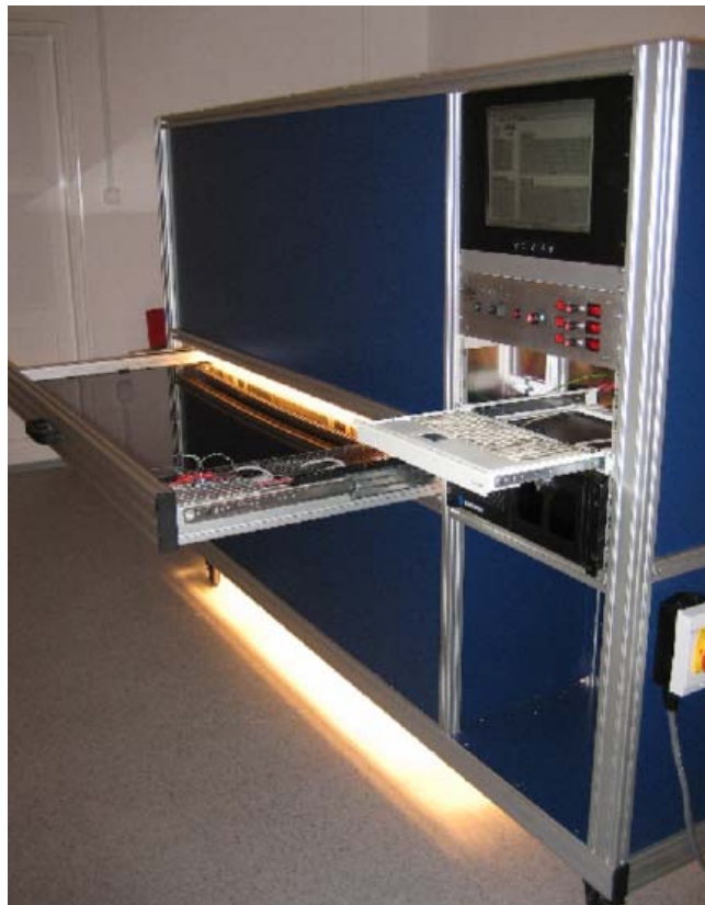
3.4. ábra. Műnap szimulátor fotovillamos modulok minősítésére (MTA TTK MFA)
