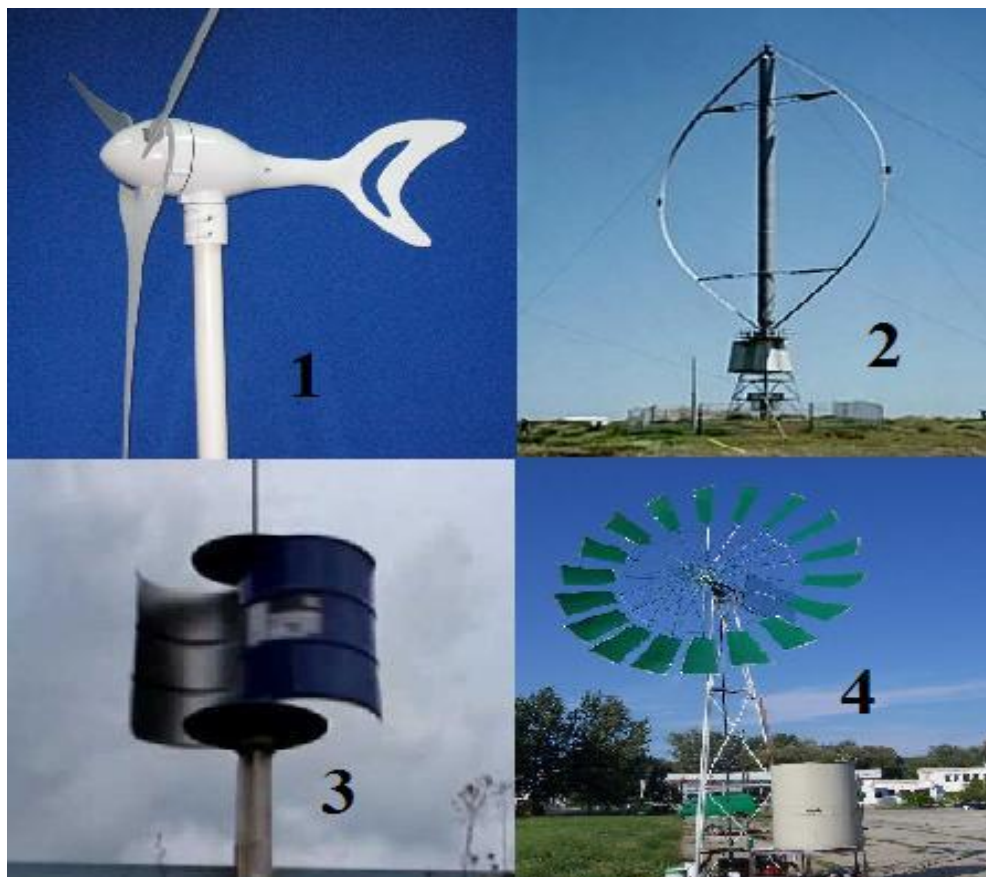
19. ábra: Szélgenerátor típusok: 1. Átlagos vízszintes tengelyű 3 lapátos turbina. 2. Függőleges tengelyű, Darrieus-turbina. 3. Függőleges tengelyű, Savonius rotor. 4. Sűrű lapátozású szélkerék.
