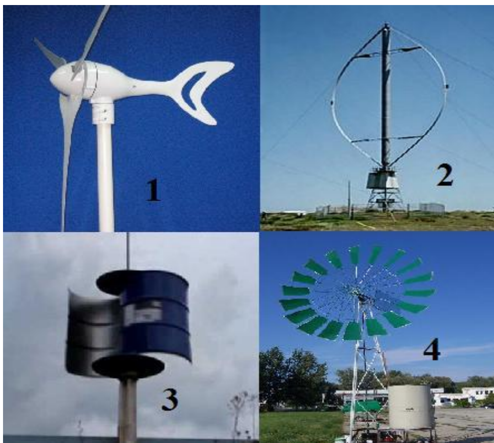
19. ábra: Szélgenerátor típusok: 1. Átlagos vízszintes tengelyű 3 lapátos turbina. 2. Függőleges tengelyű, Darrieus-turbina. 3. Függőleges tengelyű, Savonius rotor. 4. Sűrű lapátózású szélkerék.
