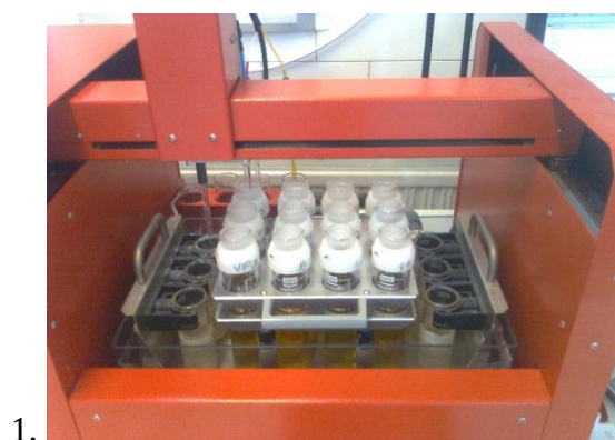
3. ábra: Adagolás automata titrátorral (1.), valamint a számítógép által vezérelt program(2.)
