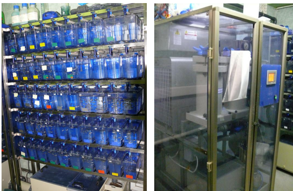
3.1. ábra Zebradánió recirkulációs rendszer. Balra halnevelő tartályok, jobbra cirkuláltató egység
