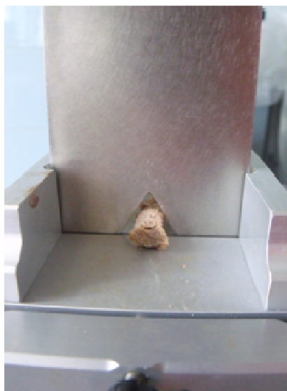
6. kép: Hús minta nyíróerő érték vizsgálata közben (saját felvétel)
