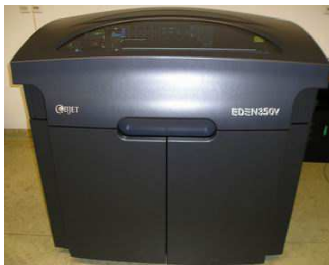
4. ábra Objet EDEN 350V berendezés a Nyíregyházi Főiskolán
