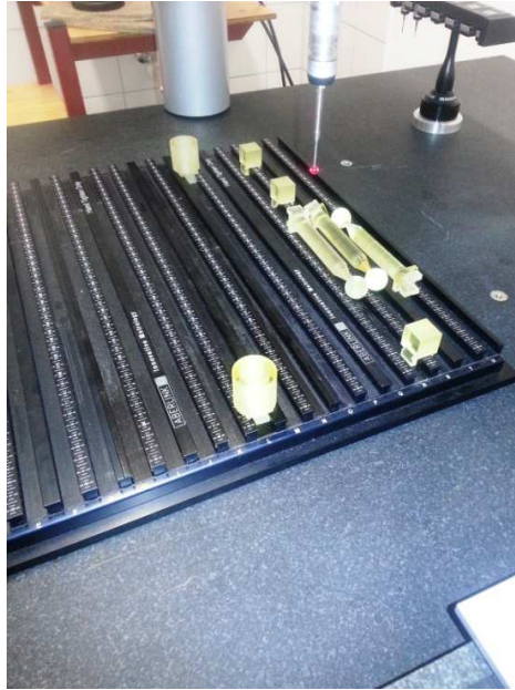
12. ábra A koordináta mérőgépben elhelyezett próbatestek
