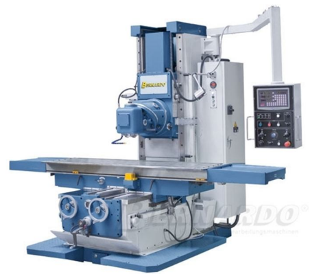
3.ábra. Bernardo BFM 2100 függőleges marógép ( Forrás: [15] )
