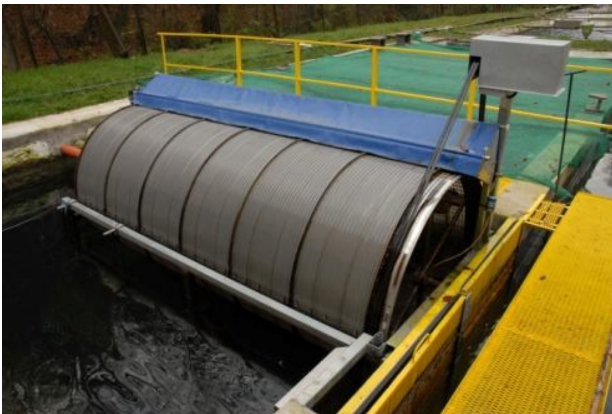
4. kép A rendszerbe épített dobszűrő
