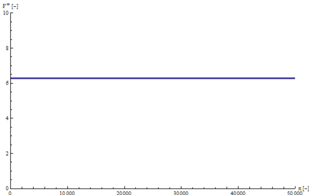
11. ábra – Ábra a szabályzásról. A leképezést egy fixpontból indítottuk el, a szabályzó programot pedig már az első iterációnál bekapcsoltuk. Látható, hogy az első 50000 iterációig működik a szabályozás.
