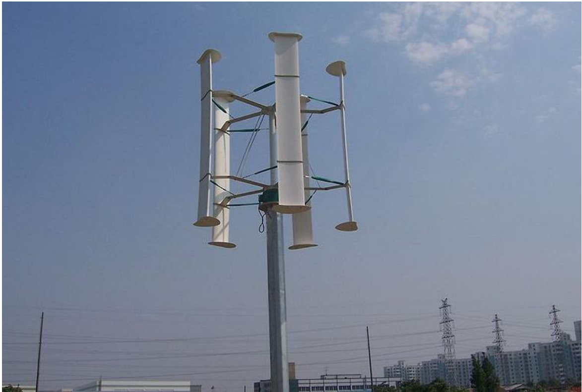
2.1 ábra: Egy korszerű Darrieus szélturbina (H-rotor) [3]
