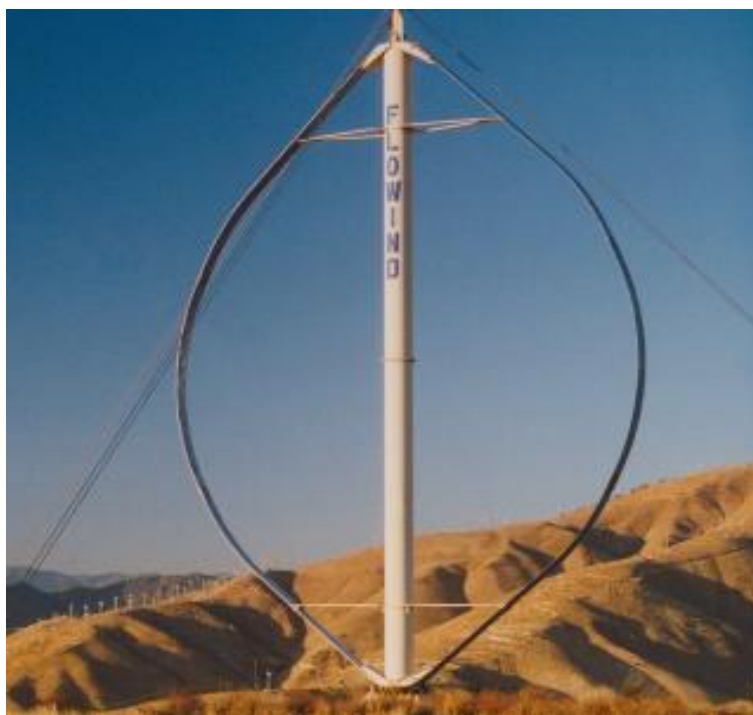
2.2 ábra: „Habverő” alakú Darrieus rotor [4]
