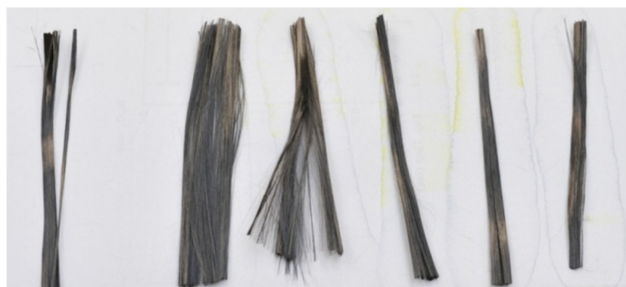
6. ábra- Szénszál minták, az acetonba mártogatást követően
