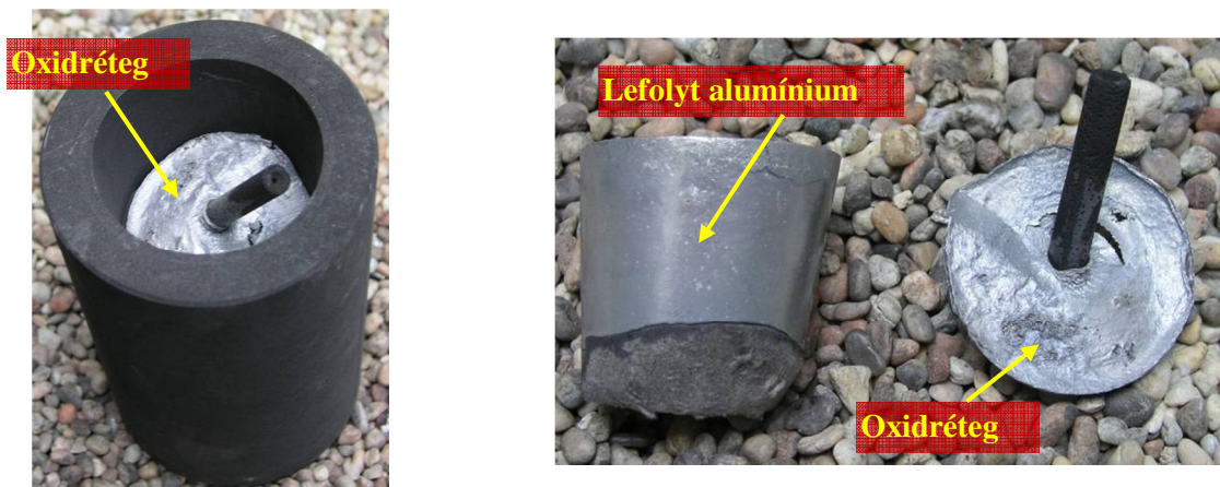
24. ábra- A hőkezelési kísérlet eredménye
