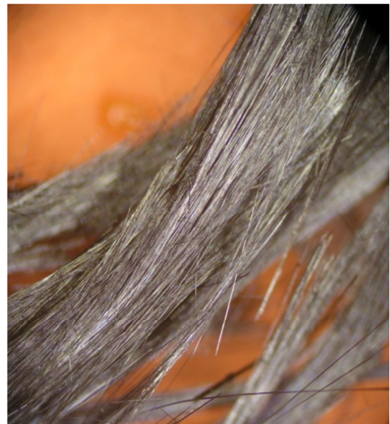
5. ábra- Sizing nélküli töredezett szálak
