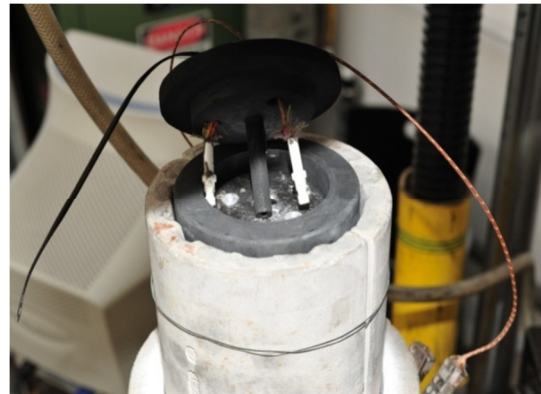
13. ábra-Termoelemek behelyezése az alumínium tömbbe
