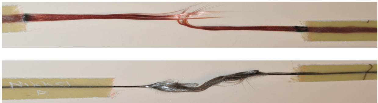
28. ábra- A réz illetve a nikkel bevonatos minták szakítás után
