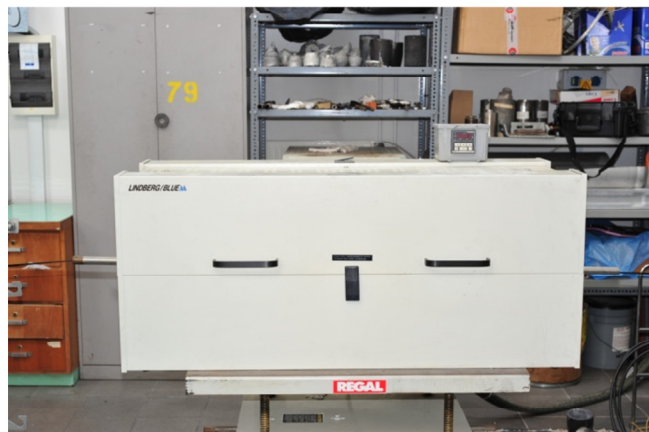
11. ábra-A bevonateltávolító csőkemence
