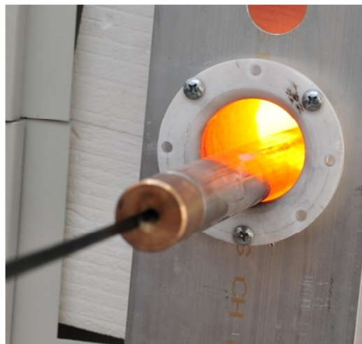
14. ábra-Bevonat eltávolító kemencéből kilépő szálköteg
