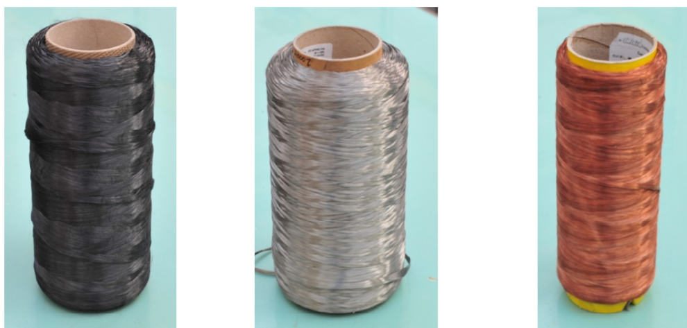
3. ábra- A Mitsubishi szálköteg, valamint a Nikkel- és Rézbevonatos szálkötegekről készült makró felvétel
