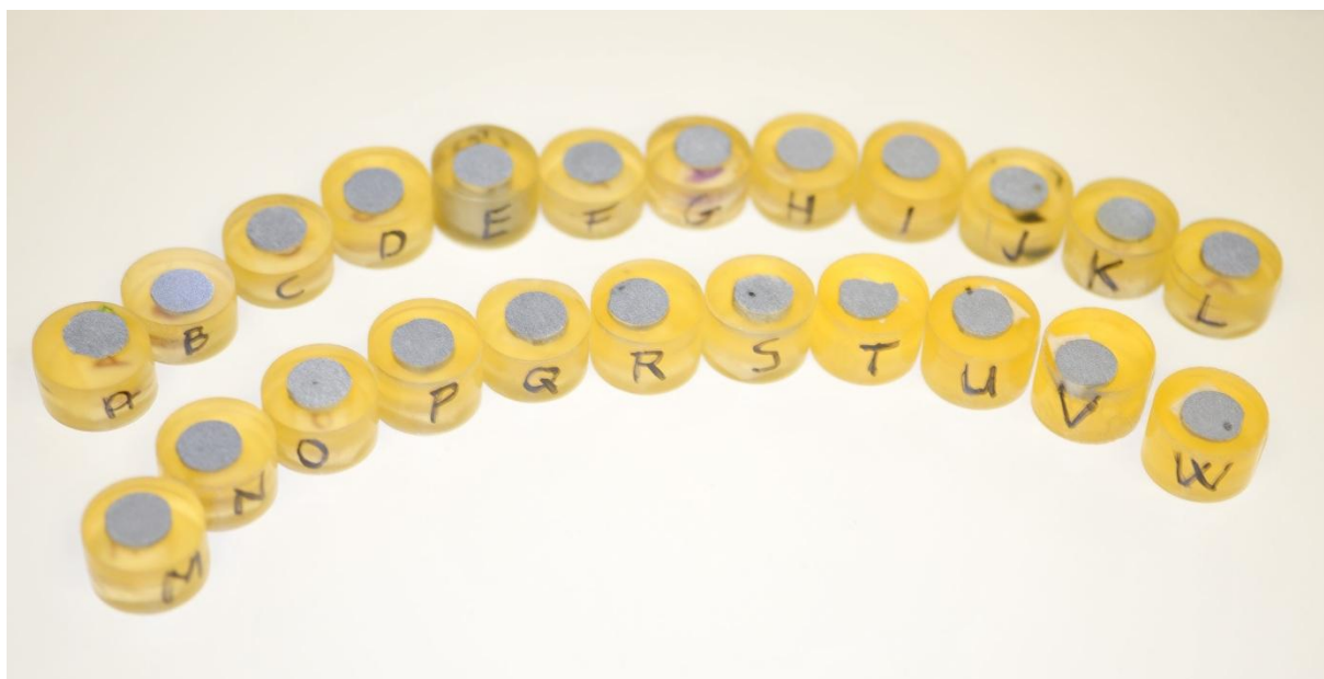
43. ábra: A kísérlet során gyártott fémhabokból kimunkált csiszolatok
