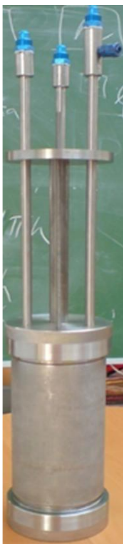
30. ábra: Az infiltráló berendezés [12].
