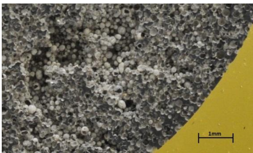
47. ábra: Egyik csiszolat felületéről készült fényképfelvételen is jól kivehető kitöltési hiány
