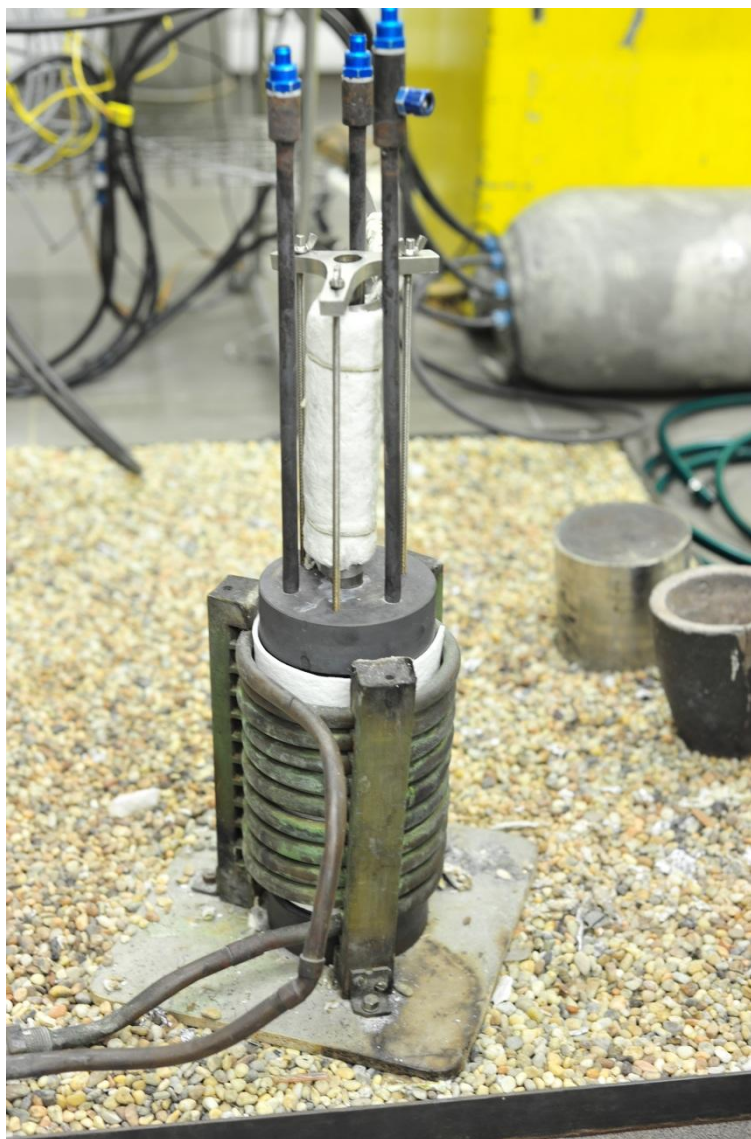
42. ábra: A kísérleti berendezés hőszigetelő paplannal az indukciós kemencében
