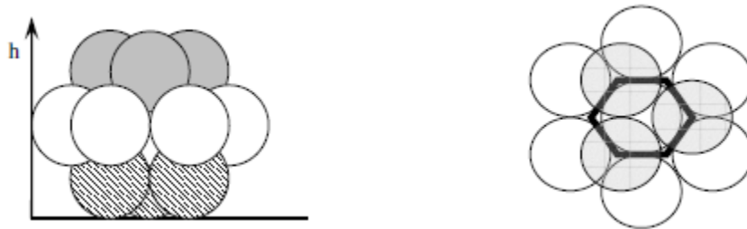
23. ábra: A CPES szerkezet a penetrációs mélység ( h ) függvényében, és az egység térfogat keresztmetszete [9].
