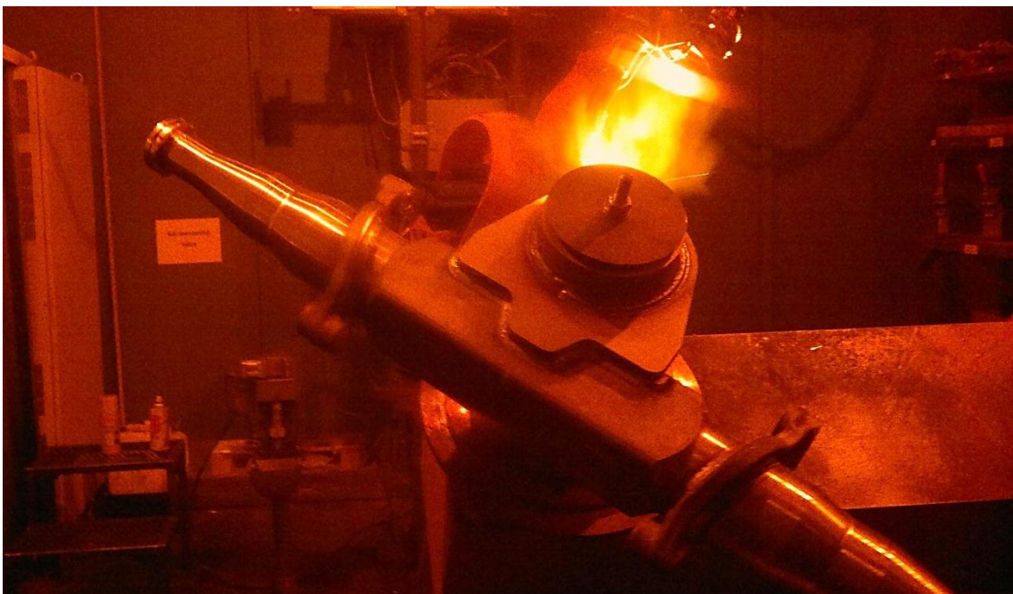
22.ábra. Megállás nélkül hegesztendő varratok hegesztése egy tömör tengelyen, tömege: ~350 kg.
