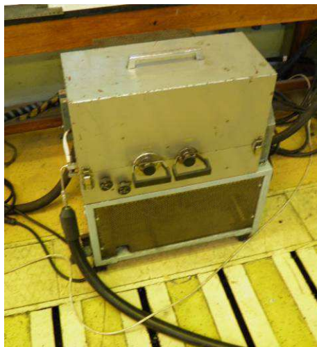
24. ábra: Az emissziómérő mintavételező egysége
