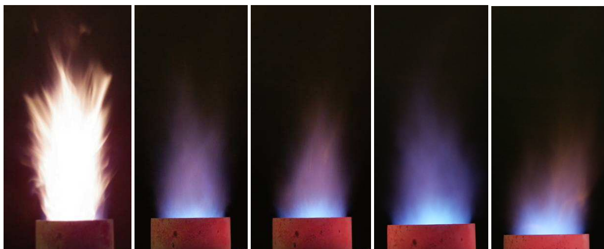
20. ábra: Vízgőz segédközeges porlasztás
