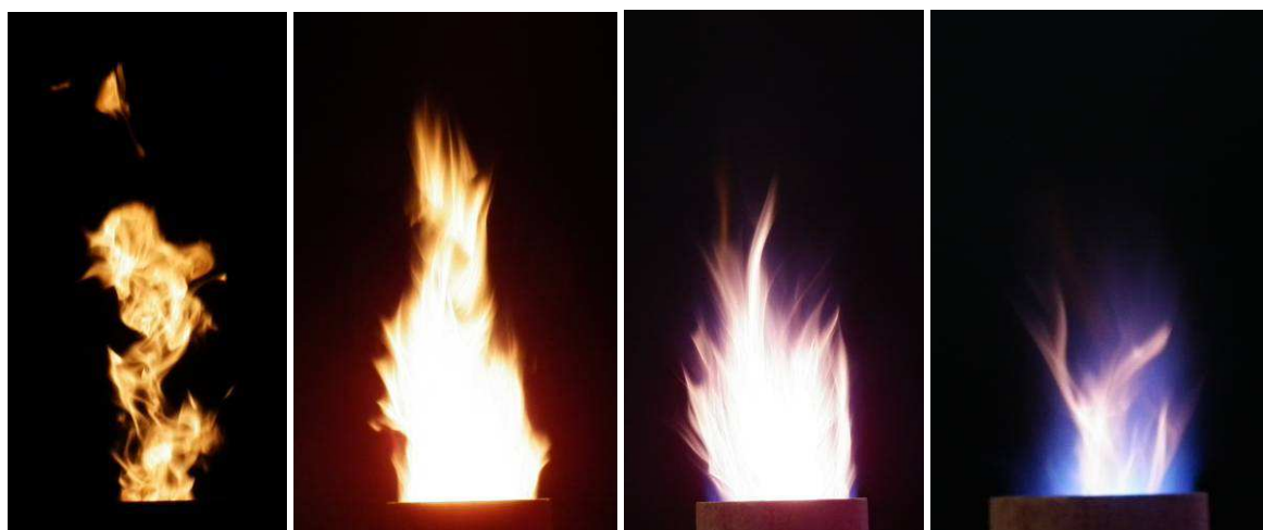
19. ábra: Levegő segédközeges porlasztás
