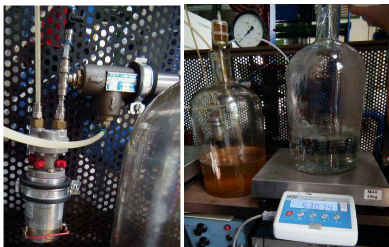
14. ábra: A hidraulikus tápegység és a mérleg a tüzelőanyaggal, valamint a porlasztási segédközeggel
