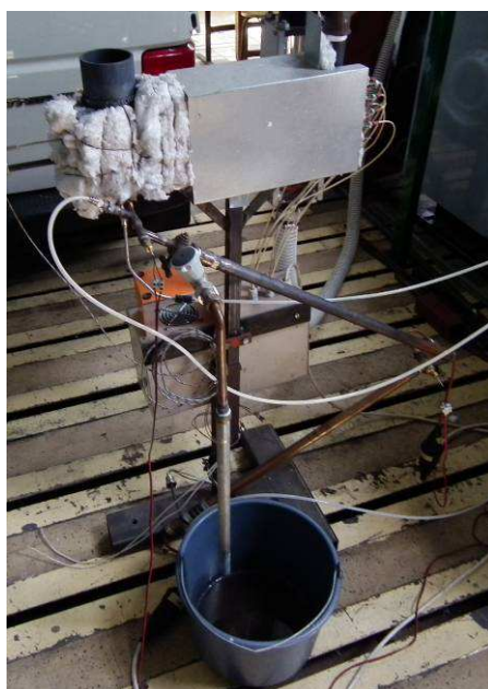
16. ábra: A levegő előmelegítő és a 2 fűtőpatron
